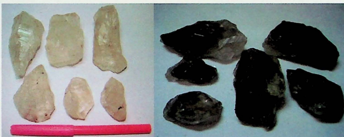
Foto 23. Cristais de quartzo incolor com brilho gorduroso (esq.) que ganharam tons esverdeados ou tons fumê após irradiação (dir.).
