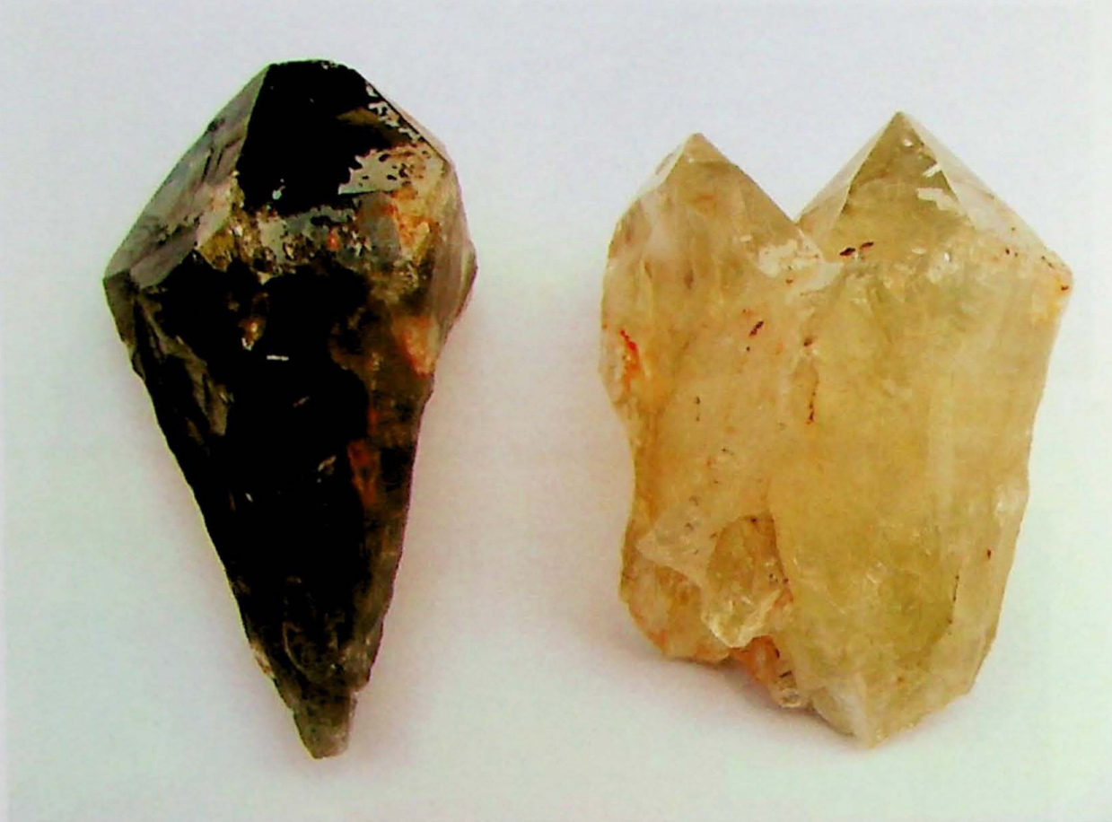
Foto 31. Amostra de quartzo levemente esverdeado (dir.) que após irradiação tornou-se verde forte (esq.).
