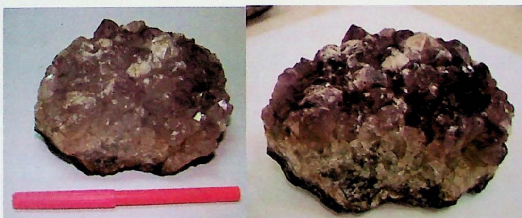
Foto 24. Amostra com base incolor e pontas fracamente roxas (esq.) que após irradiação teve sua coloração modificada para base esverdeada e pontas medianamente roxas (dir.).
