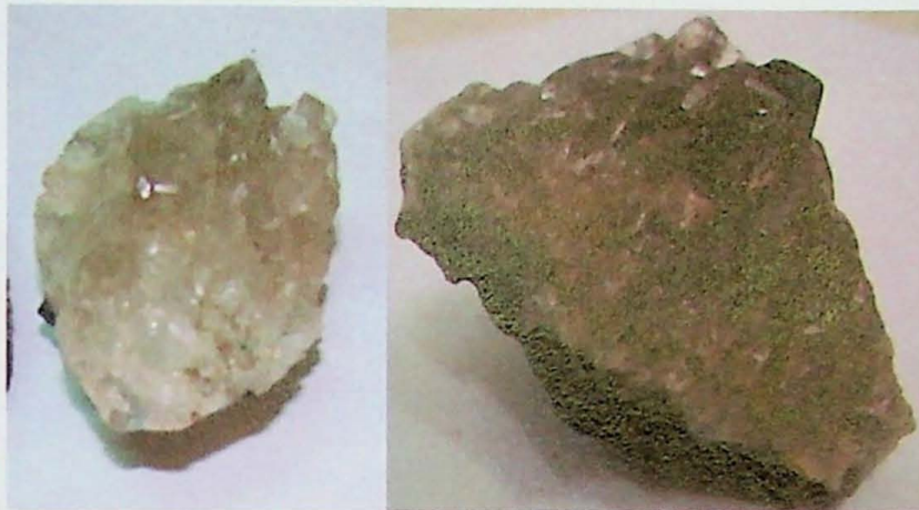
Foto 28. Amostra de quartzo incolor de brilho gorduroso (esq.) que após irradiação tornou-se fumê (dir.).
