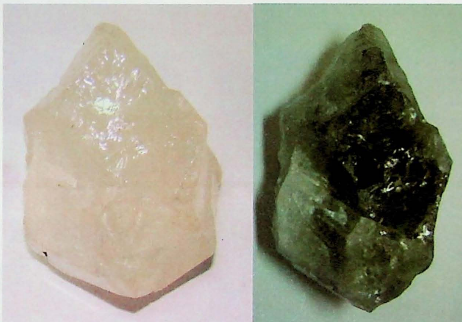
Foto 29. Amostra de quartzo incolor de brilho gorduroso (esq.) que após irradiação tornou-se verde médio (dir.).
