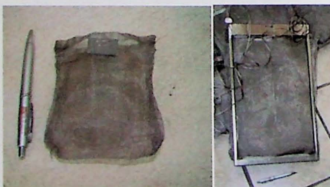
Foto 15. Sacos de metal utilizados para colocar amostras dentro d'água junto as canetas de Cobalto-60.
