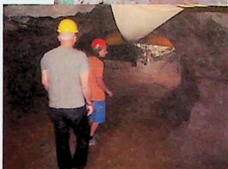
Foto 07. Entrada da galeria do garimpo visitado. Detalhe do espaço para movimentação de pessoas e retirada dos geodos. Detalhe da organização de ventilação e fiação.
