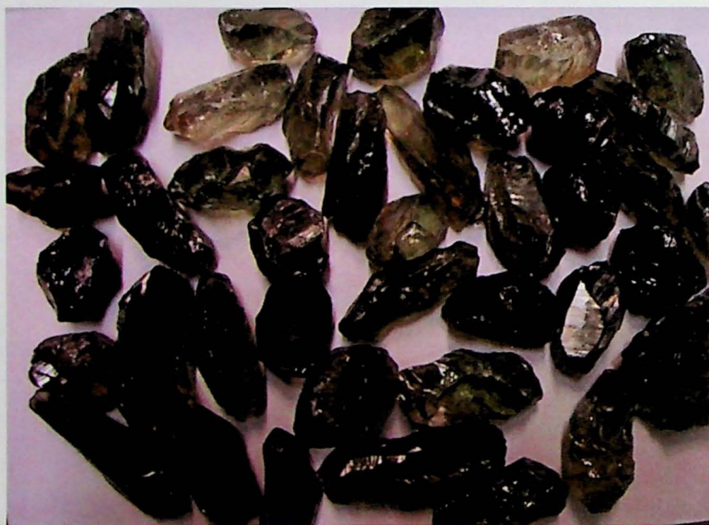
Foto 32. Amostra de quartzo incolor de Ametista do Sul que após irradiação com 400kGy produziu diversas tonalidades de verde.
