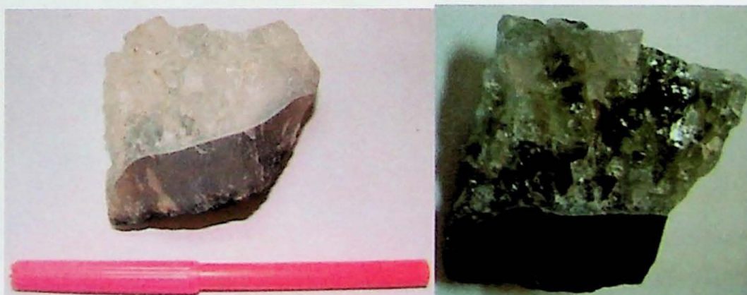
Foto 30. Amostra de quartzo incolor de brilho gorduroso (esq.) que após irradiação tornou-se verde médio (dir.).
